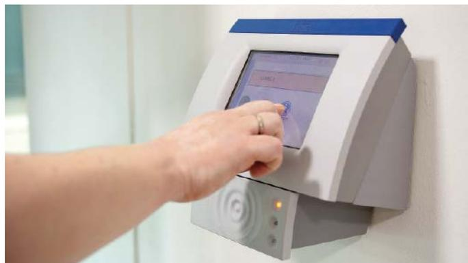
Die Mitarbeiter-Karte enthält zwei Chips: Einen für das Schließsystem blueSmart und einen für die bereits vorhandenen Terminals, zum Beispiel für die Zeiterfassung, die Kantine, für die Freischaltung der Zapfsäule und der Waschanlage
