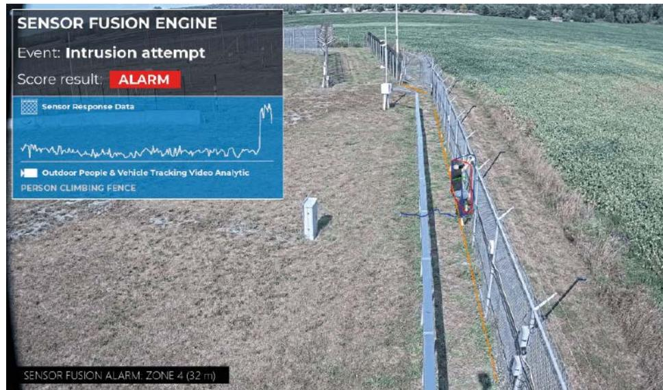
Die Sensor Fusion Engine von Senstar nutzt Metadaten von Zaunsensoren und Videoanalysen, um die höchste Erkennungswahrscheinlichkeit aufrechtzuerhalten und gleichzeitig Fehlalarme ein für alle Mal zu verhindern
