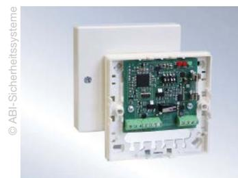
Gateway (1 P-BUS und 1 M-BUS Schnittstelle): Das Gateway ist ein Protokollumsetzer und ermöglicht die Anschaltung von M-BUS-Segmenten mit Bus-Meldern und Linienauswertemodulen (LAM) an den P-BUS (z. B. bei Erneuerung von MC 1500-8/-16-Zentralen mit der M-BUS Baugruppe 15341).
