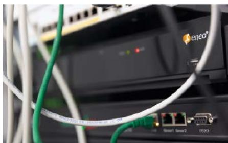
Die Aufzeichnung und Verwaltung der Videokameras erfolgt mit einem Netzwerkreorder der Eneo IN-Serie mit zwei Festplatten à 4TB, der die AI-Videoanalysefunktionen der Kameras unterstützt
