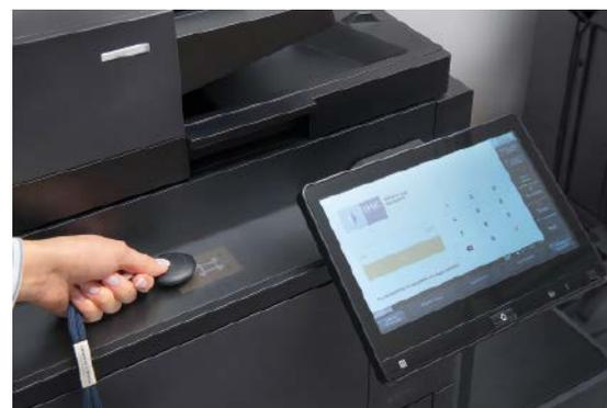
Die Transponder wurden zusätzlich mit RFID-Chips ausgestattet, so dass die Mitarbeiter beispielsweise die Multifunktionsgeräte individuell bedienen können, etwa wenn sie vertrauliche Unterlagen ausdrucken wollen
