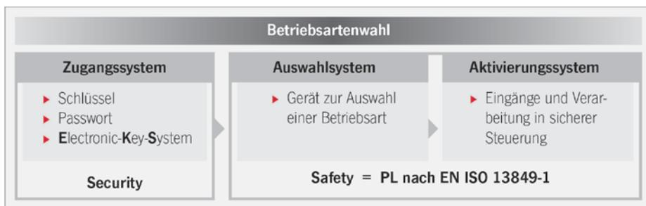
Bild 2 – Sicherheitstechnische Beurteilung eines Betriebsartenwahlschalters
