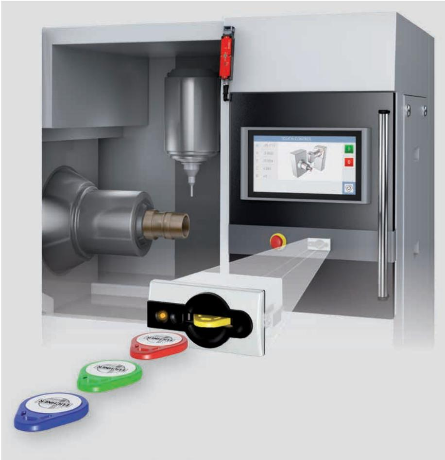
Ein Betriebsartenwahlschalter ist an fast allen Maschinen vorhanden – meist in Form eines Schüsselschalters. Künftig wird vermehrt eine sicherheitstechnische Bewertung der Betriebsartenwahl gefordert werden. Einige Normen, beispielsweise für Dreh- und Schleifmaschinen, verlangen diese Bewertung bereits heute.
