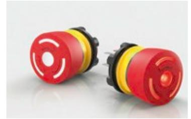
Zu den Vorteilen zählen der robuste Monoblock mit hoher Überlist- und Ausfallsicherheit, ein attraktives Design und Schutzart IP65/67 sowie eine lange Lebensdauer. Der Betätigungsstatus ist aufgrund des grünen oder schwarzen Anzeigerings gut sichtbar. Die LED-Ausleuchtung hilft beim Auffinden der Taste, auch bei schwachen Lichtverhältnissen, und dient als zusätzliche Statusanzeige.
