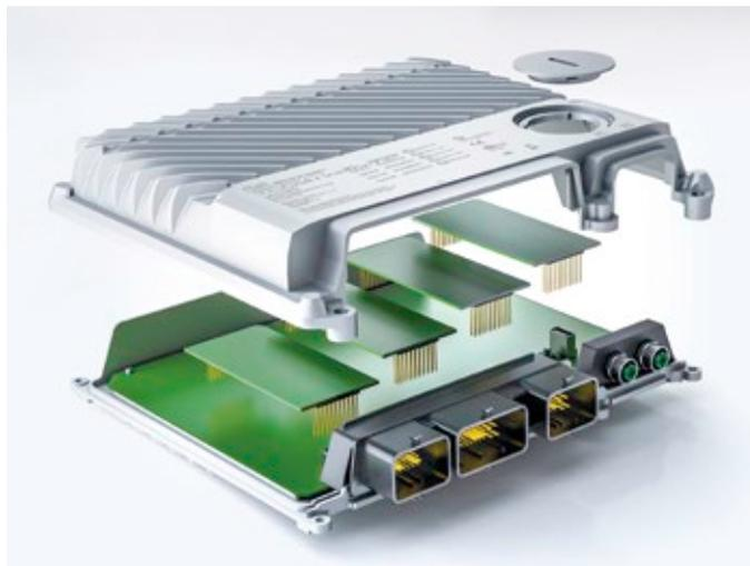
Durch den modularen Aufbau der X90-Steuerung lassen sich zusätzliche Funktionen, wie Interfaces, Condition Monitoring oder zukünftig auch sichere I/Os mit PLe, einfach ergänzen
