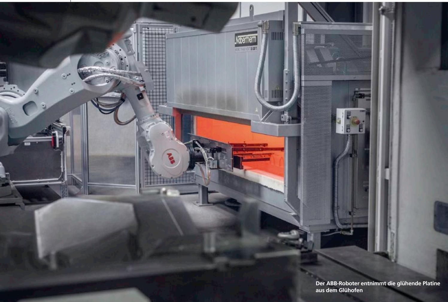
Der ABB-Roboter entnimmt die glühende Platine aus dem Glühofen
