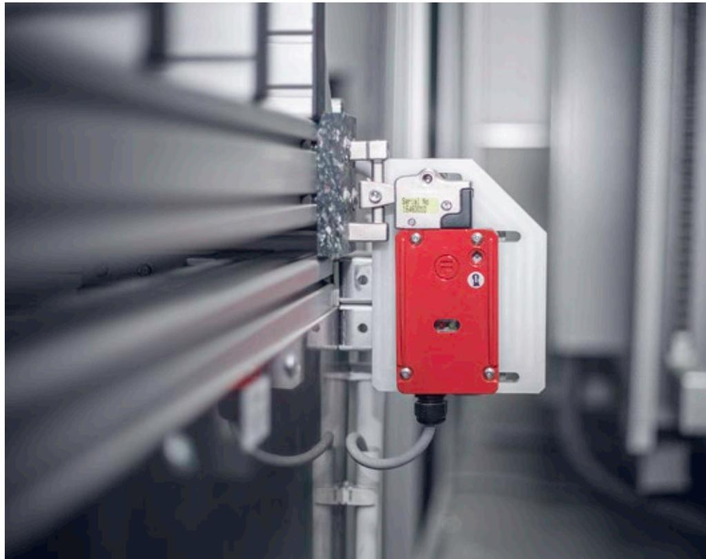
Die Sicherheitszuhaltung von amGardPro von SSP am Inneren des Bereitstellisches
