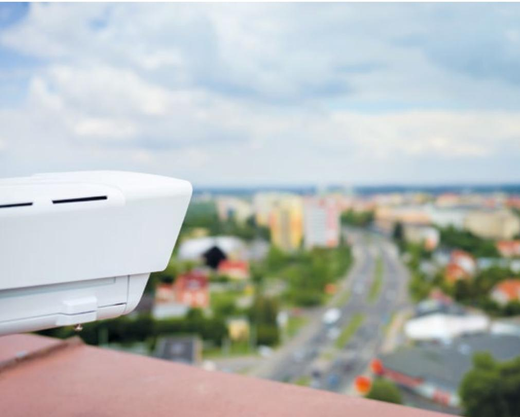
Kameras erfassen und analysieren mittels Sensoren und Software den Verkehrsfluss. Besonders an Verkehrsknotenpunkten oder zentralen Umschlagplätzen des ÖPNV ist das sinnvoll
