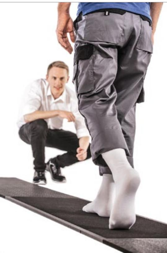
▲ Die Vermessungsdaten aus 3D-Scanner und Druckmessplatte (im Bild) fließen in die Fertigung individueller Schuhe und in die Produktion von Einlagen im 3D-Druckverfahren
