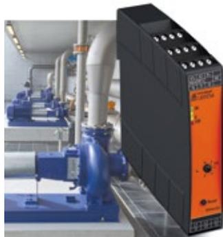
tischen Drehfeldkorrektur dafür, dass immer ein Rechtsdrehfeld am Motor anliegt. Dazu analysiert ein Mikroprozessor die Nulldurchgänge der drei Phasen und erkennt die Phasenfolge. Somit ist ein Drehen in die falsche Richtung nicht möglich.
