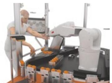
Handarbeitsplätze am Track, indem Shuttle-Geschwindigkeit und Kraft der Shuttles sicher begrenzt werden. In anderen Bereichen des Tracks fahren die Shuttles mit voller Dynamik.
