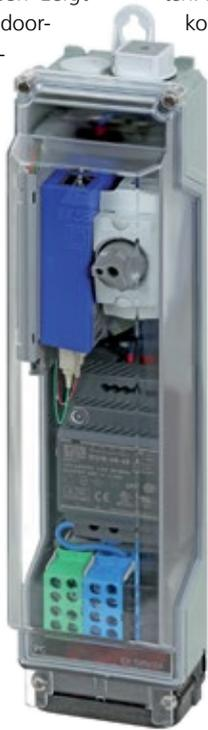
ten. Insgesamt stehen fünf vorkonfigurierte Systeme bereit: eine passive Variante mit Spleißkassette, Pigtails und Kupplungen sowie vier aktive, die zusätzlich einen Medienkonverter, ein Netzteil, eine Sicherung und Klemmen für den Anschluss der Versorgungsleitung haben. Die Medienkonverter unterstützen Fast- oder Gigabit-Ethernet sowie wahlweise PoE+ mit einer Leistung von 30 W bzw. einem Strom von bis zu 600 mA. Verbindungsleitungen für die Verkabelung im Mast sind auf Anfrage erhältlich.
