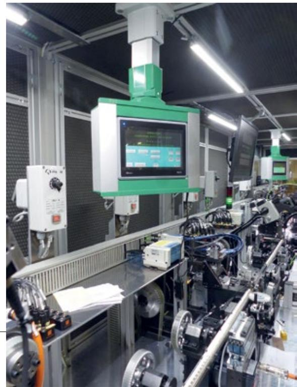
▲ Das Leichtsteuergehäuse CC-4000 in einer selbst entwickelten Produktionslinie der Firma Lumberg
