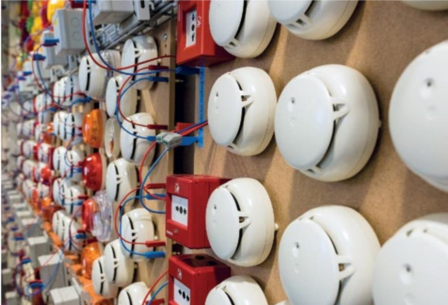
Das Testsystem ist in der Lage, alle möglichen Situationen zu simulieren und durch einen „virtuellen Prüfer“ die normenkonforme Funktionalität zu überprüfen und zu bestätigen
