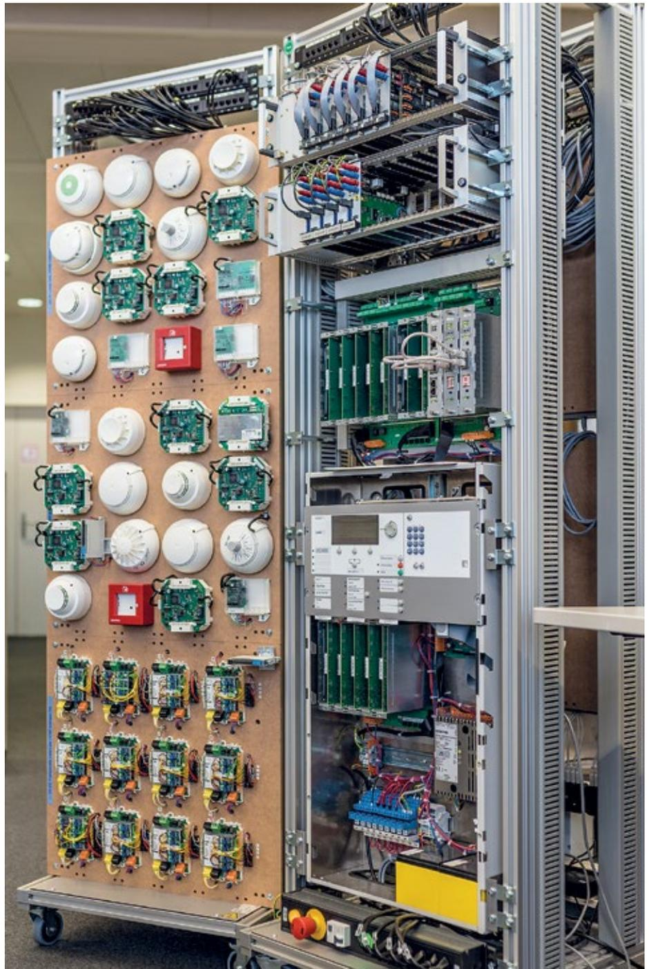
Ein automatisiertes Testsystem setzt sich aus intelligent kombinierten realen und simulierten Komponenten zusammen
