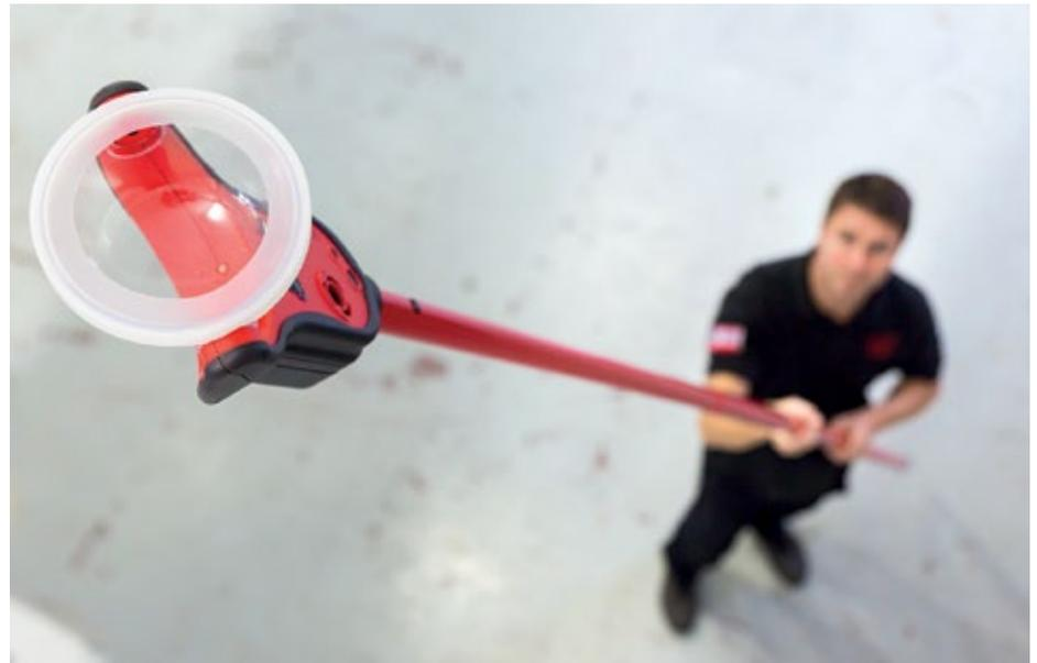
„Solo 365“ für Rauchansaugsysteme: Durchsichtige Schale zur Prüfung von Punktmeldern gegen den RAS-Adapter tauschen
