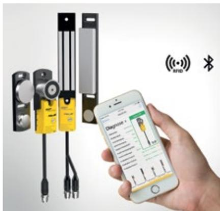
einfach in Reihe schalten. Die Leitung wird einfach durchgeschleift und damit der Verkabelungsaufwand massiv reduziert. Die Besonderheit dabei: Über einen internen Bus, der ganz ohne Gateway zur übergeordneten SPS ausgewertet werden kann, lässt sich jede einzelne Einheit separat ansteuern. Eine Bluetooth-Schnittstelle ermöglicht dem Anwender außerdem
