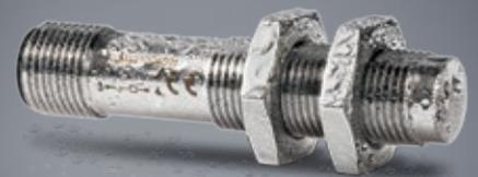
Der Sicherheitssensor 122MSV ist speziell für die Anwendung in der lebensmittelverarbeitenden Industrie entwickelt. Sein komplett gedichtetes Edelstahlgehäuse widersteht intensiven Reinigungen mit aggressiven Medien bei extremen Temperaturen von -25 °C bis +80 °C (Schutzart IP6K9K). Zudem zählt er zu den kleinsten Sicherheitssensoren am Markt.
