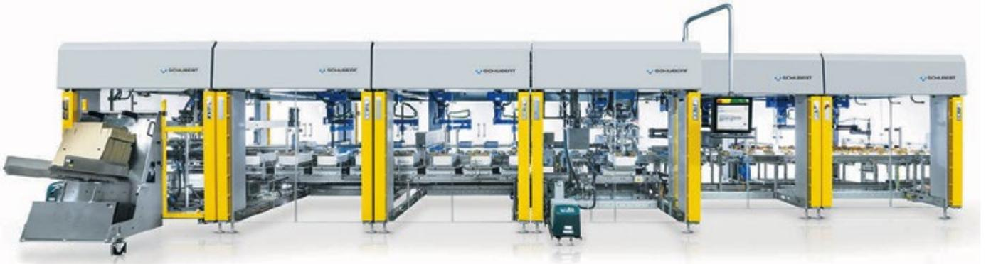
Die TLM-Endverpackungsanlage von Schubert verpackt Croissants und Plundergebäck in zwei unterschiedlichen Trayformaten und kann jederzeit für andere Produkt- und Trayformate ausgebaut werden. Auch in solch eine Anlage ließe sich das CKS System einbauen
