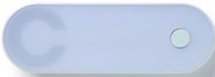
**Zentrale des Systems: Kommunikation mit der Online-Plattform und der App via M2M-Mobilfunk, mit den Türkomponenten via Wireless-Technologie**
