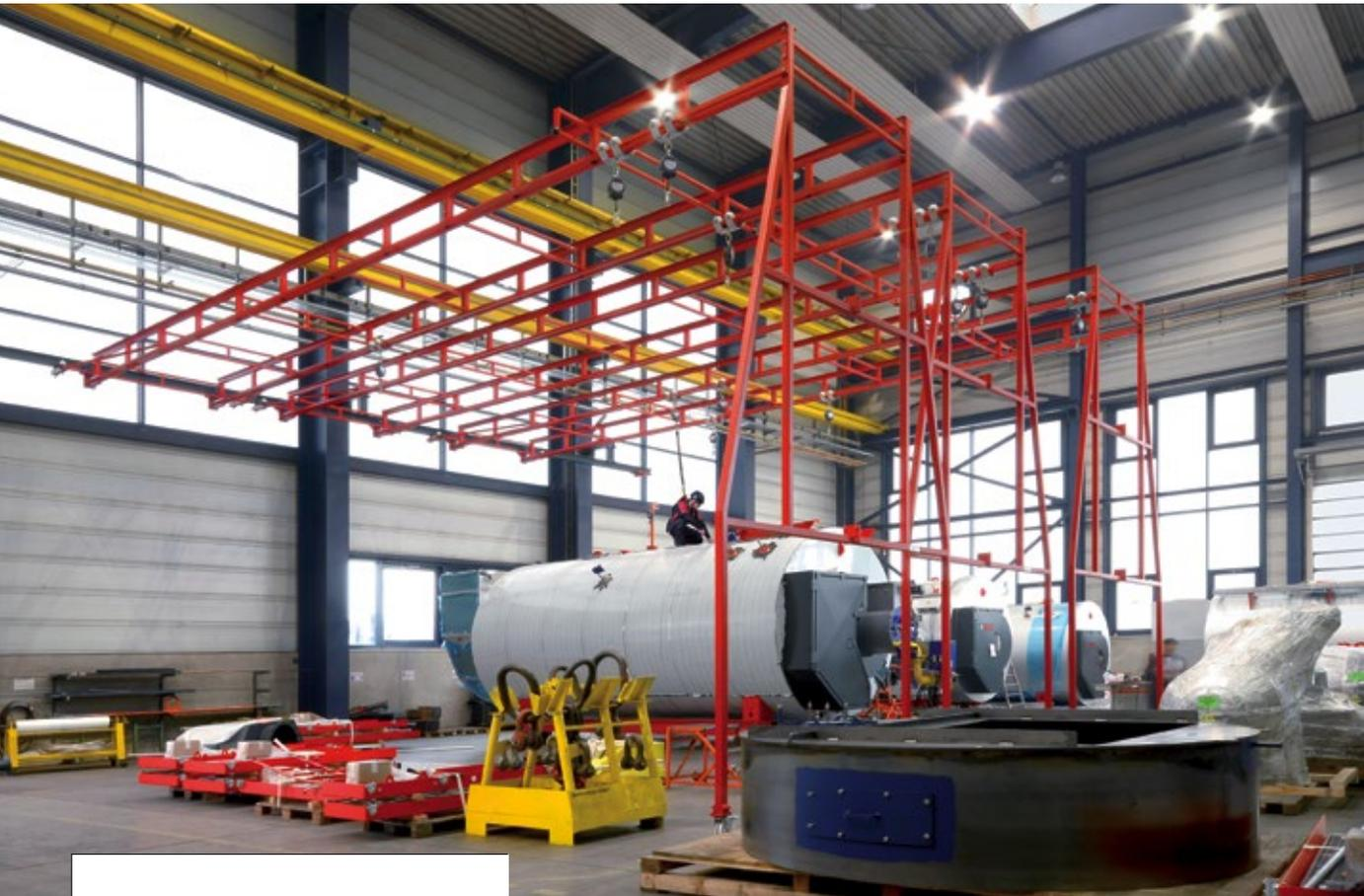
Speziell angefertigte Absturzsicherung – maßgeschneidert passt sie optimal in die Halle
