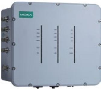
Moxas TAP-6226 ist ein neues Komplettsystem für die sichere Zug-zu-Strecke-Kommunikation, das zwei Wireless Access Points, einen Managed-Glasfaser-Switch und eine AC/DC-Stromversorgung mit breitem Spektrum integriert. Mit einem IP-68-Gehäuse und Schock- sowie Vibrations-sicheren M12-Steckern wurde es speziell für den Schienenverkehr konstruiert. „Aufgrund der Zug-zu-Strecke-Kommunikation, die
