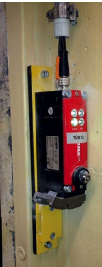
Sicherheitsschalter CET in Kombination mit Riegelsystem an der Zugangstür zum Gehege
