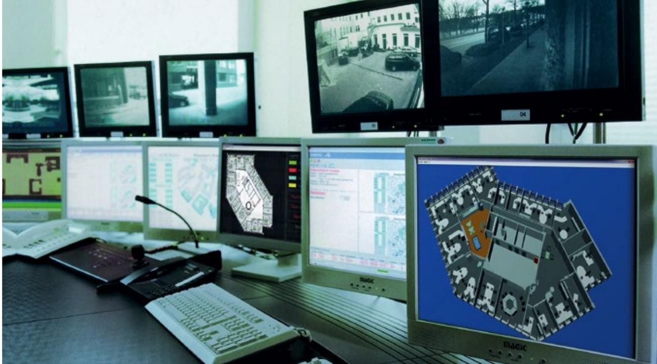
Das Gefahrenmanagementsystem Winmag plus von Honeywell verbindet unterschiedliche Gewerke zu einem integrierten modularen System und bietet eine einheitliche Benutzeroberfläche für Lösungen aus den Bereichen Videoüberwachung sowie Brand- und Einbruchschutz. Mit der 3D-Ansicht in der aktuellen Version Winmag plus V5 können Sicherheitsverantwortliche schnell erkennen, wo ein Alarm auftritt und mit welchen Maßnahmen am besten darauf zu reagieren ist
