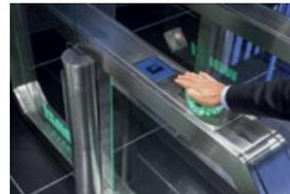
der Firma Wanzl, die in Verbindung mit dem biometrischen Zutrittsleser Intus PS eine sichere Personenuauthentifizierung mit Handvenenbiometrie ermöglicht.
