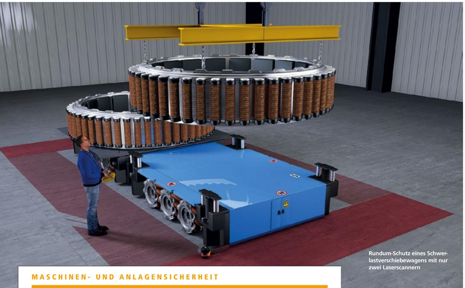
Rundum-Schutz eines Schwerlastverschiebewagens mit nur zwei Laserscannern
