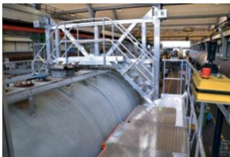
**Über den dachseitigen Überstieg kann das Wartungsteam schnell und sicher von einer Seite auf die andere wechseln. Dank der flexiblen Ausschübe lassen sich die Arbeitsplattformen exakt an die unterschiedlichen Kesselwagenprofile andocken und die Arbeitsfläche um 50% erweitern**
