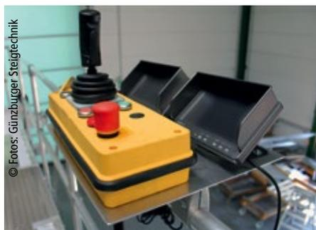
**Mit Hilfe der Joy-Stick-Bedienung und der Kameraüberwachung kann die Arbeitsbühne auch im Ein-Mann-Betrieb von oben aus gesteuert werden**
