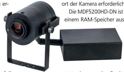
Die Kamera liefert bis zu 2K-Full-HD-Videomaterial bei bis zu 30 fps bei voller Auflösung (1.080p/30). Sie verfügt über ein motorgetriebenes Megapixel-Varifokal-Objektiv, das perfekt auf den Bildsensor abgestimmt ist. Die Einstellung von Zoom, Fokus und Blende erfolgt somit komfortabel über einen Web-Browser, und es ist keine manuelle Objektiv-Einstellung am Montageort der Kamera erforderlich.
