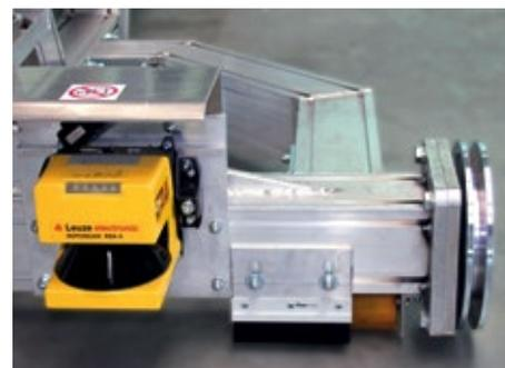
**Laserscanner mit Auto-Stopp-Funktion sorgen für höchste Sicherheit beim Verfahren und im Betrieb der Arbeitsbühne**
