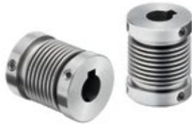
Standardkupplungen dienen sie für eine Korrektur von Winkelfehlern zwischen Antrieb und Drehgeber und für den Ausgleich von axialem und radialem Versatz. Um eine sichere, andauernde Anbindung zu realisieren, bestehen die Balgkupplungen aus Edelstahl. Dadurch können sie hohem Schock und Vibrationen ausgesetzt werden.
