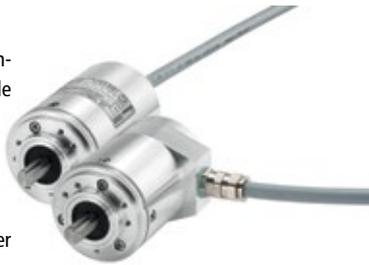
seewasserfestem Aluminium, das die Schutzart von IP67 aufweist. Die Geber sind damit selbst für Offshore-Anlagen geeignet und absolut salzwasserfest. Sie arbeiten in der inkrementalen Variante flexibel mit einer Auflösung von bis zu 5.000 Impulsen und leisten dank ihres weiten Temperaturbereichs von  $-40^{\circ}\text{C}$  bis  $+60^{\circ}\text{C}$  auch im rauen Alltag zuverlässig ihre Arbeit. [www.kuebler.com](http://www.kuebler.com) ■
