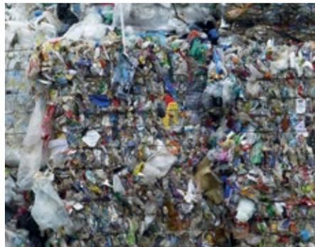
Die hochkalorische Fraktion von Verpackungsabfällen, die nicht stofflich recycelt werden können, lässt sich ideal zu Ersatzbrennstoff für die Zementherstellung verarbeiten
