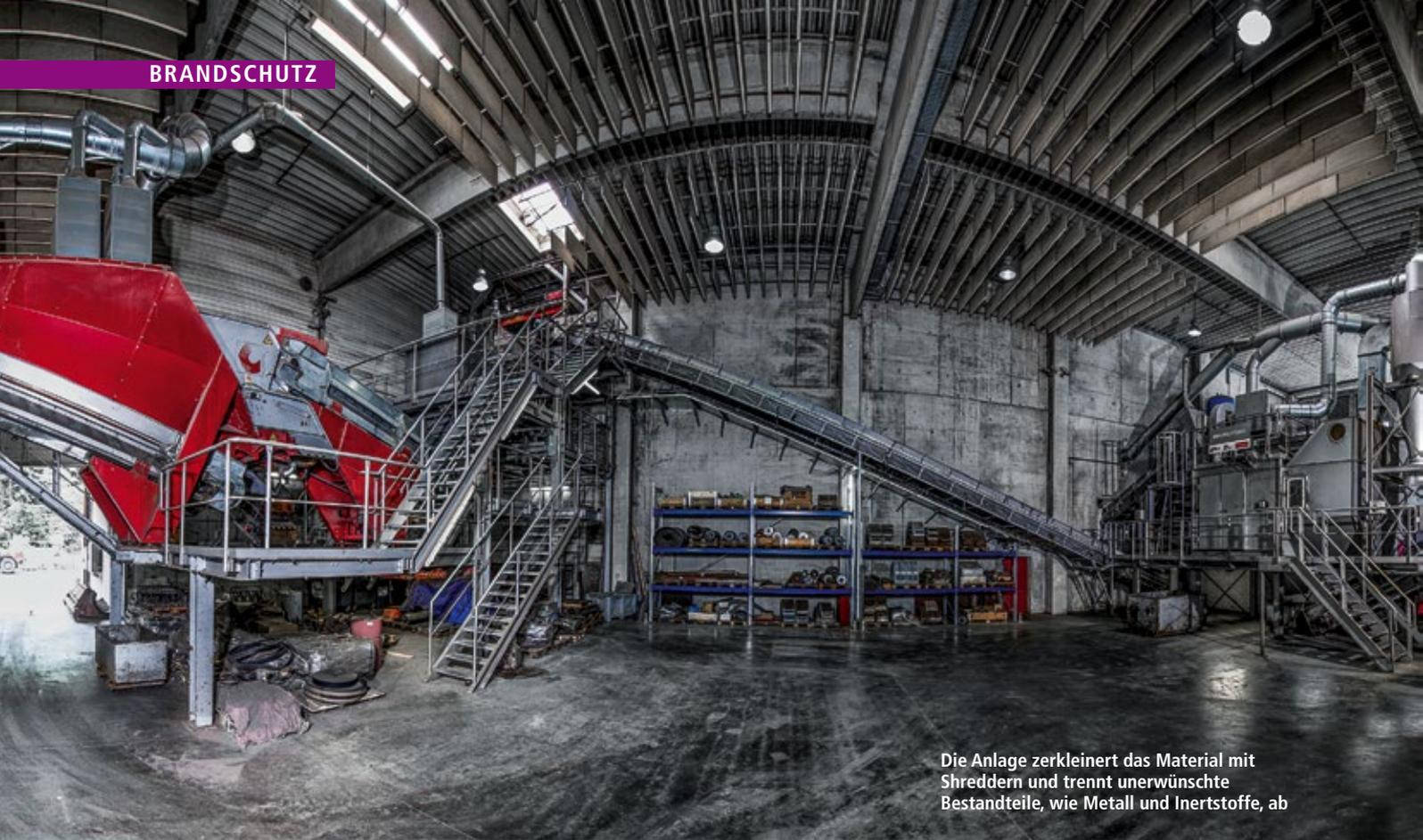
Die Anlage zerkleinert das Material mit Shreddern und trennt unerwünschte Bestandteile, wie Metall und Inertstoffe, ab
