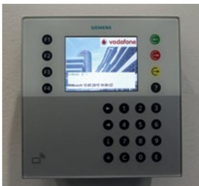
Die Zeiterfassungsterminals werden derzeit noch mittels Berechtigungskarten aktiviert – durch die integrierte NFC-Technologie bieten die Terminals die Voraussetzung für eine zukünftige Bedienung mittels Mobiltelefon mit NFC-SIM-Karte
