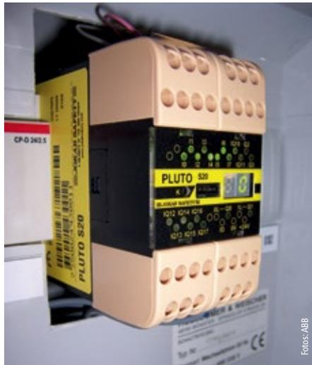
Die „All Master“ Sicherheits-SPS Pluto S20 vereinfacht den Entwurf von Sicherheitssystemen und entspricht dem Performance Level PL e nach EN ISO 13849-1 sowie SIL 3 nach IEC-62061
