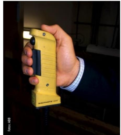
Der dreistufige Zustimmungstaster JSHD4 dient der sicheren Durchführung von Einricht-, Wartungs- und Servicearbeiten. Bei panikartigem Durchdrücken oder Loslassen schaltet die Anlage unverzüglich ab
