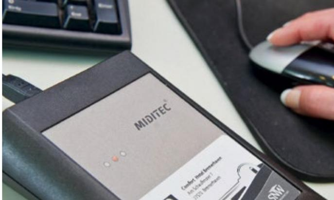
Die Schlüsselkarte wird einfach auf das Gerät gelegt – so wird sie mit der Berechtigung beschrieben
