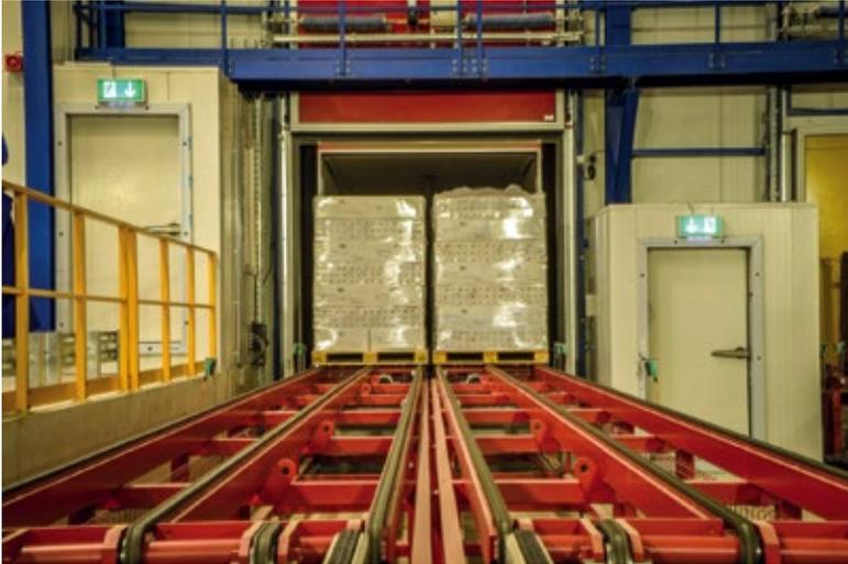
Das automatische Be- und Entladensystem ermöglicht es, einen Lastwagen mit 32 Paletten in nur zwei Minuten vollständig zu entladen
