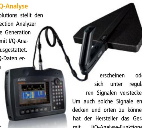
erscheinen oder sich unter regulären Signalen verstecken. Um auch solche Signale entdecken und orten zu können, hat der Hersteller das Gerät mit I/Q-Analyse-Funktionen ausgestattet. Es nimmt mit maximal 32 MHz Kanalbreite die I/Q-Daten in Echtzeit auf und speichert bis zu 250.000 I/Q-Datenpaare unverdichtet, d.h. ohne Datenverlust. [support.narda-de@L-3com.com](mailto:support.narda-de@L-3com.com)
