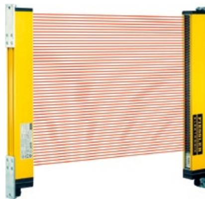
einem Lichtsender und einem Lichtempfänger mit integriertem Schaltgerät. Für den sogenannten Fingerschutz (min. Detektion  $\varnothing$  14 mm) sind Reichweiten bis zu 10 m möglich. Für den Handschutz (min. Detektion  $\varnothing$  30 mm) sind Reichweiten bis zu 30 m realisierbar. Durch
