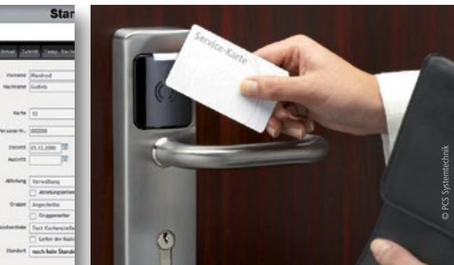
▲ Abb. 2: Mittels Servicekarte erfolgt die Parametrierung des Türterminals
