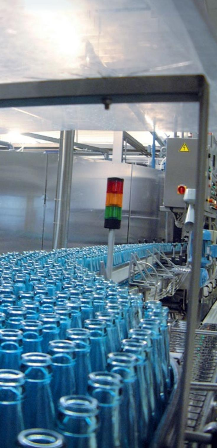
▲ **Fördertechnik für Glasflaschen** mit Staubbahnkontrolle und sensorischer Überwachung
