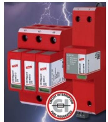
Dehnguard M...CI mit integrierter Ableiterversicherung. Bei diesem universell einsetzbaren Überspannungsableiter Typ 2 beinhaltet das Schutzmodul sowohl den eigentlichen Überspannungsableiter als auch eine Ableiterversicherung. [info@dehn.de](mailto:info@dehn.de) ■
