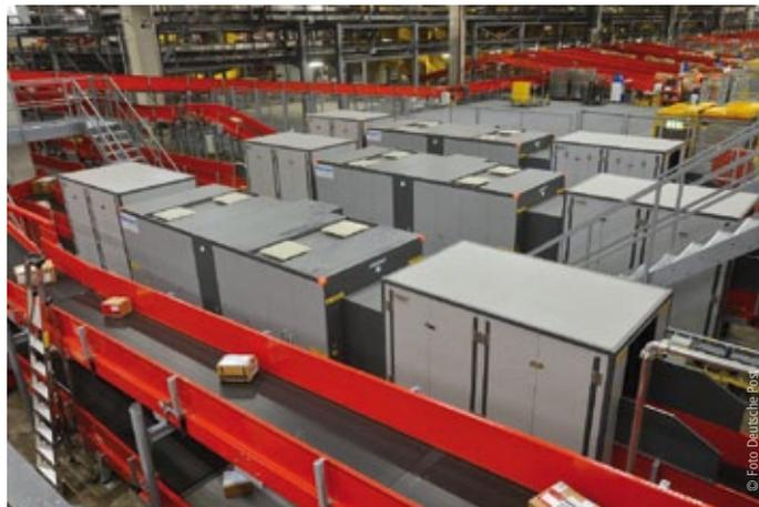
▲ Automatisierte Röntgenanlage DHL Air Hub Leipzig
