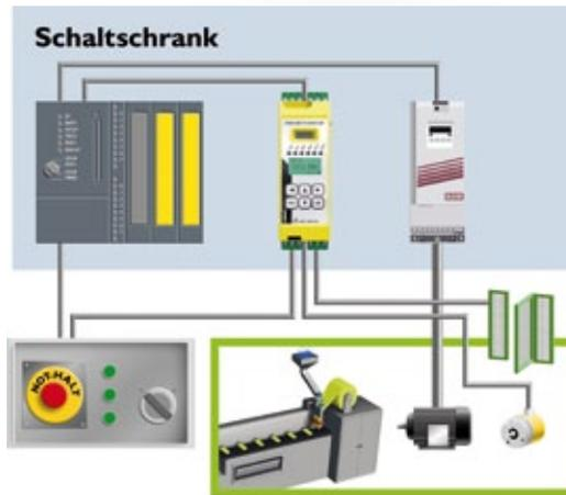
◀ **Abb. 4:** Anbindung der sicheren digitalen Ausgänge von PSR-Motionstop an STO-Eingänge eines Frequenzumrichters oder eine übergeordnete Steuerung
