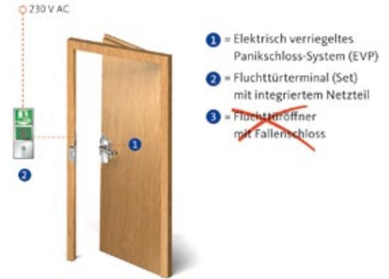
▲ Elektrisch verriegeltes Panikschloss im Zusammenspiel mit der Fluchttürsteuerung FTNT
