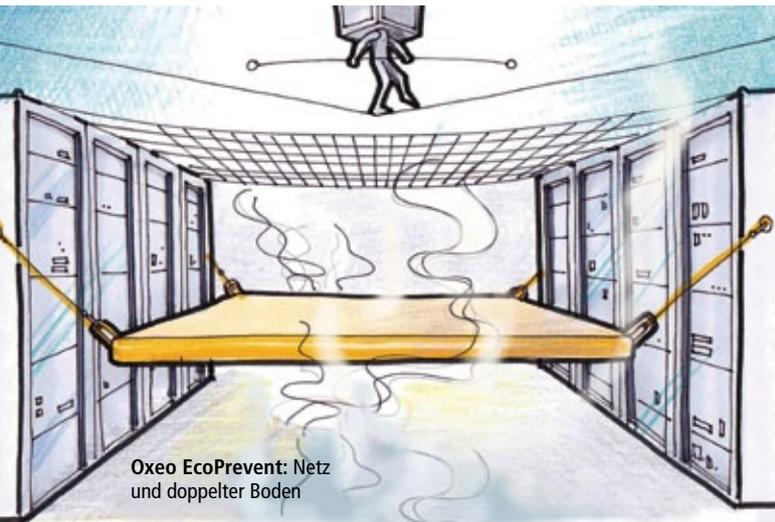
**Für Rechenzentren hat die permanente Datenverfügbarkeit höchste Priorität. Gleichzeitig bergen die komplexe technische Ausstattung und die dort eingesetzten Materialien ein hohes Brandrisiko. Das Oxeo EcoPrevent-System von Minimax bietet durch den bedarfsgesteuerten Einsatz von Inertgasen, wie Argon oder Stickstoff, energieeffizienten Brandschutz auf höchstem Sicherheitsniveau.**
