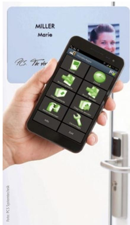
Abb. 2: Das NFC-Smartphone oder eine RFID-Karte zur Zutrittskontrolle.
