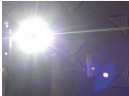
▲ Diese Bilder zeigen deutlich den Wert einer guten Vergütung. Das Test-Chart im Hintergrund ist klar sichtbar, obwohl sehr helles Licht auf das Objektiv trifft.
