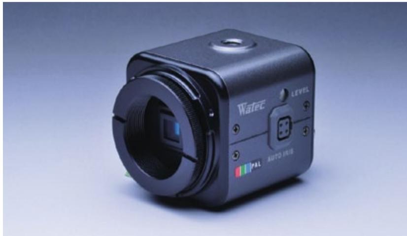
Bei der neuen WAT 600CX kann sowohl die Videosignal-Übertragung und auch die Stromversorgung der Kamera über ein Koaxialkabel erfolgen, und das bis zu einer Länge von 150 m. Die Kamera ist sehr hochempfindlich bis 0,02 lx (F1.2) und hat eine Auflösung von 540 TVL. Die kompakte Bauform B 42 x H 42 x L 50 mm bietet optimale Voraussetzungen für die verdeckte Videoüberwachung. Der Auto-Iris Ausgang ist kompatibel für beide Objektive mit DC und videosignal gesteuerten Blenden. Das Objektiv-Aufla-
