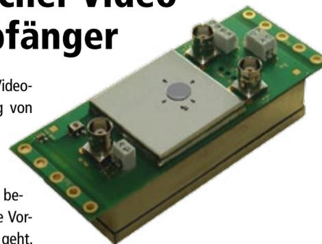
Leistungsmerkmale sind die automatische Kompensation falscher Senderimpedanzen z. B. bei Baluns, eine Signalausfallerkennung mit editierbaren Fehlertexten und einer Meldung über die RS485 Schnittstelle sowie eine Schrift- und Dateneinblendung. Eine integrierte Potentialtrennung, die automatische Korrektur von Polaritätsfehlern sowie die Optimierung im Hinblick auf Tag-/Nacht-kameras runden das Funktionsspektrum ab.
