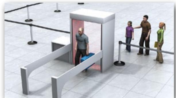
Personenschleusen werden an Flughäfen mit Sick-Lichtgittern ausgerüstet, um eine zuverlässige Vereinzelung und Richtungserkennung der Personen zu erreichen.
