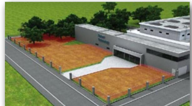
**Horizontalüberwachung nach Bedarf:** Bei Nacht wird die gesamte Freifläche überwacht, bei Tag wird der Zufahrtsweg von der Überwachung ausgenommen und ist so ohne Alarm nutzbar.
