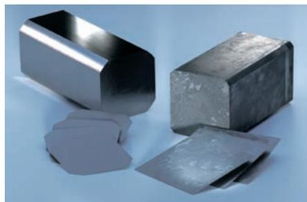
Siliziumblock und einzelne Wafer
