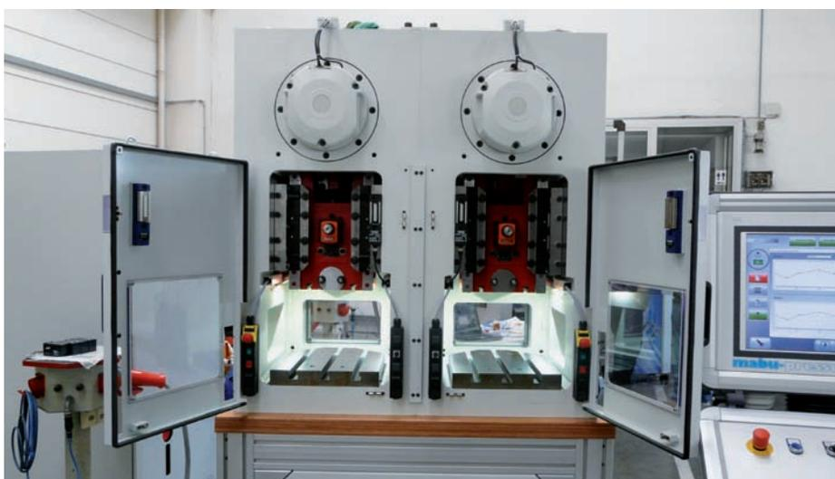
**Abb. 3:** Doppelmodul mit geöffneten Schutztüren – gut zu erkennen: je zwei Bedienfelder der BDF-Baureihe.
