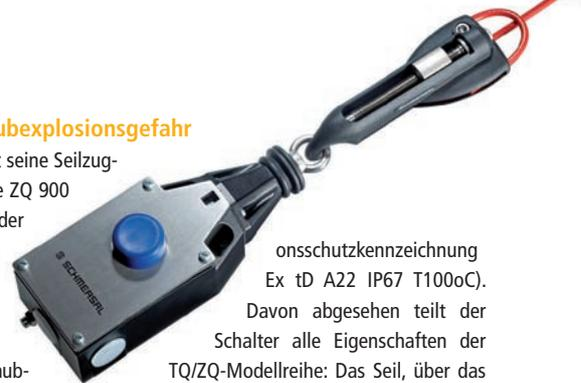
onsschutzkennzeichnung Ex tD A22 IP67 T100oC). Davon abgesehen teilt der Schalter alle Eigenschaften der TQ/ZQ-Modellreihe: Das Seil, über das die Not-Halt-Funktion betätigt wird, kann bis zu 50 Meter lang sein. Die integrierte Seilrissüberwachung sorgt für Sicherheit auch in kritischen Einsatzfällen. Eine Seilzustands- bzw. -spannungs-anzeige erleichtert die Einrichtung und Wartung des Systems. [info@schmersal.com](mailto:info@schmersal.com)
