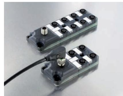
oder acht Steckplätze sind ebenfalls in M12 (mit vier bzw. fünf Pins) ausgeführt. Damit können über die vergoldeten Kontakte dann ein oder zwei Signale pro Steckplatz übertragen werden. [info@murrelektronik.com](mailto:info@murrelektronik.com)
