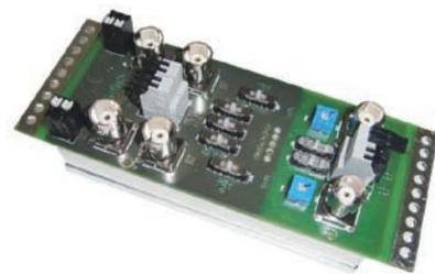
vielfältige Einsatzmöglichkeiten. Im Falle von vorhandenen CAT- bzw. Fernmeldeleitungen sind z.B. mit dem VAE-119 als zweikanaligem Zweidrahtempfänger preiswerte und wartungsfreie Übertragungsstrecken realisierbar. Der geringe Platzbedarf, die Potentialtrennung und die hohe Bildqualität auch bei größeren Reichweiten sind gut geeignet für die Integration analoger Videosignale in zentrale digitale Encodersysteme. info@mhm-electronic.de
