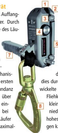
Geschwindigkeit erreichen. Wird diese überschritten, greift die zweite unabhängige Sicherung. Eine Fliehkraftbremse schwenkt den Fangriegel aus und blockiert den Läufer. Möglich ist dies durch eine eigens dafür entwickelte und patentierte Mikro-Fliehkraftbremse, die trotz kleinster Bauform bereits bei niedrigen Umdrehungen ein hohes Drehmoment übertragen kann. [www.skylootec.de](http://www.skylootec.de)
