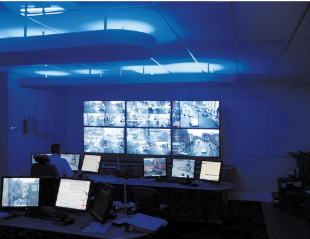
Die neuen TFT-LCD-Monitore Eye-LCD4200-24NB und 4700-24NB von Eyevis mit einer Bildschirm-diagonale von 42" bzw. 47" liefern hohe Bildqualität, hohe Auflösung und sind besonders für Anwendungen geeignet, die rund um die Uhr laufen müssen. Mit einem ultradünnen, schlanken Gehäuse und den schmalen Rahmen sind sie hervorragend geeignet für Videowände: Die Lücke zwischen den Bildern zweier benachbarter Moni-
