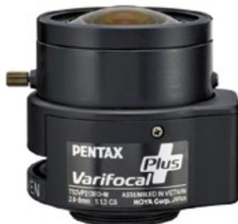
die patentierte Kopplung der Fokus- und Zoommechanismen gelingt es dem Hersteller, die sonst getrennten Bewegungen der einzelnen Linsengruppen so in einem Varioobjektiv zu koordinieren, dass über den gesamten Brennweitenbereich kein Nachfokussieren erforderlich ist. Feichtner.thomas@pentax.de ■
