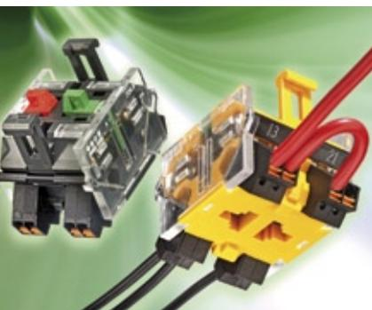
EAO bietet eine Anslusstechologie für seine Baureihe 04 an. Die Baureihe 04 PIT (Push-In-Terminals), die mit Federkraftklemmen von „Phoenix Contact“ ausgerüstet ist, reduziert Anschlusszeiten um bis zu 70 % im Vergleich zu Produkten mit Schraubanschluss. Die Federkraftklemme gewährleistet einen
