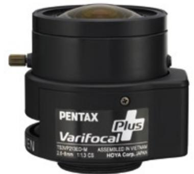
Durch die patentierte Kopplung der Fokus- und Zoommechanismen ist es Pentax gelungen, die üblicherweise getrennten Bewegungen der einzelnen Linsengruppen in einem Varioobjektiv zu koordinieren, so dass über den gesamten Brennweitenbereich ein Nachfokussieren nicht mehr nötig ist. Das Objektiv erfüllt die erweiterten Anforderungen an eine bessere Bildwiedergabe plus zeitsparender Installation.
