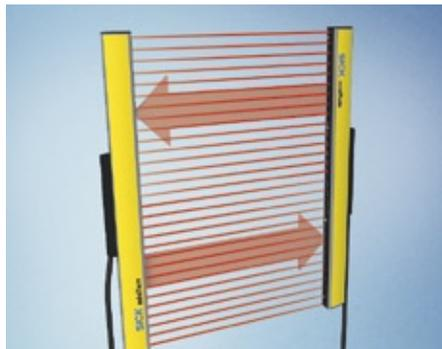
Das sichere Schutzfeld entsteht durch eine um 180° verdrehte Montage von zwei miniTwin-Sticks zueinander, so dass sich die Sender- und die Empfängermodule gegenüber befinden.
