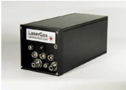
Von Bernt Messtechnik und NEO Monitors AS wird zur Achema 2009 ein neuer Gasanalysator zur kontinuierlichen Messung der Gaskomponente Fluorwasserstoff (HF) vorgestellt, welcher auch kurzzeitig auftretende Konzentrationsspitzen schnell und sicher erkennen kann. Das nach SIL2 eingestufte, kompakte und leichte Gerät (110 x 110 x 220 mm; 1,8 kg) benutzt das Elektronikdesign der dritten Generation der bekann-
