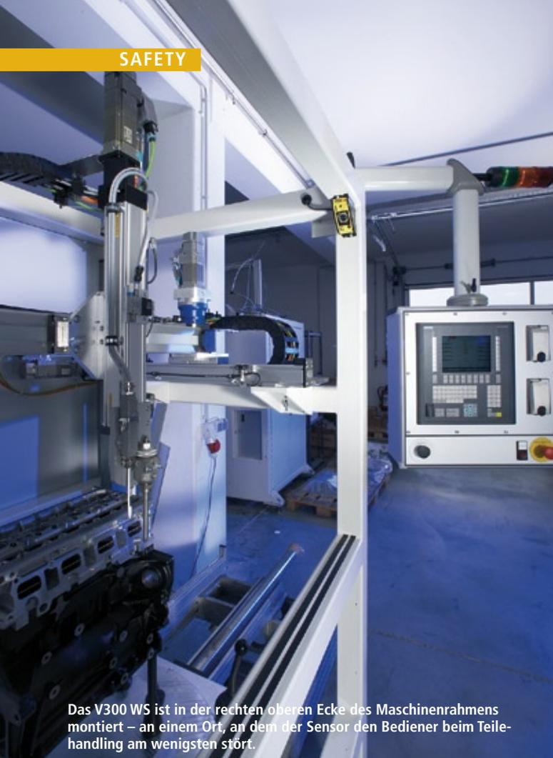
Das V300 WS ist in der rechten oberen Ecke des Maschinenrahmens montiert – an einem Ort, an dem der Sensor den Bediener beim Teilehandling am wenigsten stört.
