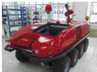
der Onboard-Sensorik für die situative Einsatzplanung. Das Fahrzeug selbst ist mit einem speziellen Splitter- und Hitzeschutz ausgestattet. Zusätzlich können Module montiert werden, z.B. Berge- oder Räumvorrichtungen.
