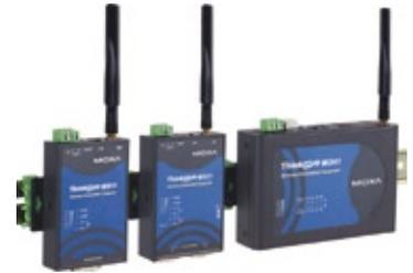
Wand- oder Hutschienenmontage. Der Computer widersteht 5 g kontinuierlicher Vibration und 50 g Schock und arbeitet zuverlässig bei  $-10^{\circ}$  bis  $60^{\circ}\text{C}$ .
