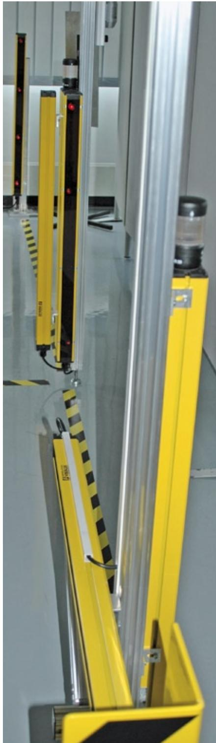
**Optische Schutzfelder: Die Absicherung am hinteren Ende der Prüfstrecken übernehmen, für jede Prüfstrecke getrennt, zwei 4-strahlige Lichtgitter des Typs SLP10-4. (Foto: Pepperl+Fuchs)**
