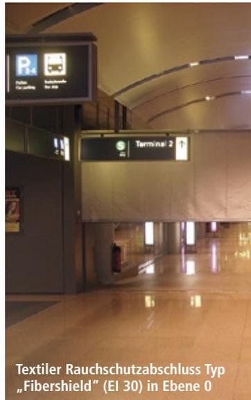
Textiler Rauchschutzabschluss Typ „Fibershield“ (EI 30) in Ebene 0
