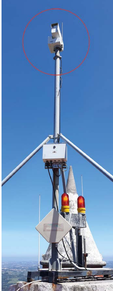
▲ Drei Industriekameras von Baumer verbergen sich in einer Schwenk- und Neigeeinheit. Eine 360-Grad-Erfassung dauert am Tag vier bis sechs Minuten, in der Nacht 12 Minuten
